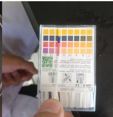
Hasil pengujian pH dengan kertas indikator universal
