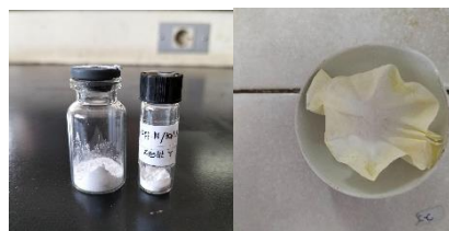
Gambar 6. (a) Seed gel , (b) Feedstock gel , (c) Overall gel setelah proses hidrotermal dan (d) Zeolit NaY setelah dikeringkan (I. Susanti, et al. , 2022).
