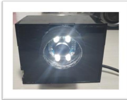
Gambar 1. Bentuk Fisik Prototype Deteksi Warna untuk Penderita Buta Warna Menggunakan Sensor TCS3200 Berbasis Arduino Uno
