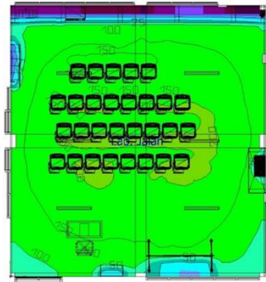
Gambar 6. Konytur iluminan kondisi eksisting Lab. Perkerasan Jalan
