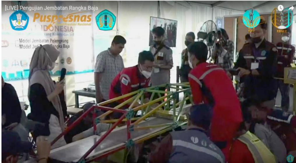
Gambar 3. Dokumentasi Pengujian Beban Jembatan Model Sumber : Penulis (2022)
