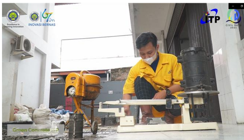
Gambar 2. Pegujian berat isi beton segar
