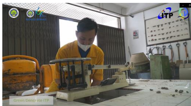
Gambar 3. Pegujian berat jenis beton kering
