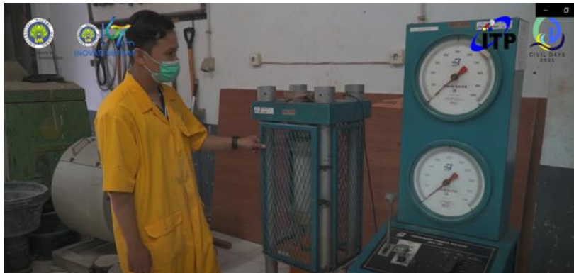
Gambar 4. Pegujian kuat tekan
