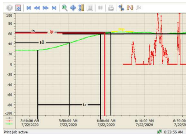
Gambar 11. Kurva Respon terhadap Set Point 60°C dengan nilai K_p=22 , T_i=1857.72 , T_d=97.22
