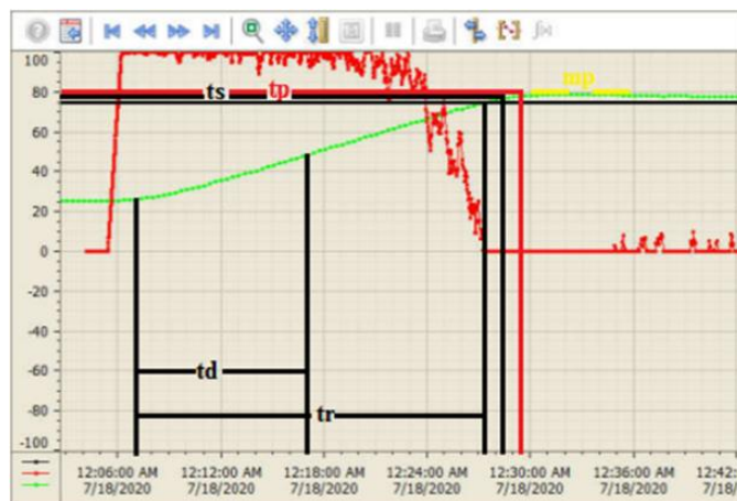
Gambar 9. Kurva Respon Terhadap Set Point 75°C dengan Nilai K_p=14.22 , T_i=330.6 dan T_d=81.5
