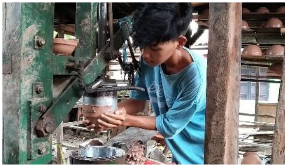
Gambar 10. Proses Pembuatan Gerabah Teknik Press
