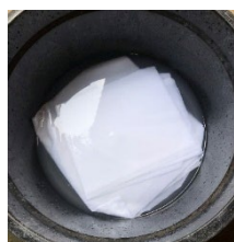
Gambar 3. Proses perendaman kain menggunakan TRO
