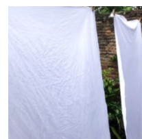
Gambar 4. Proses penjemuran kain setelah Mordanting
