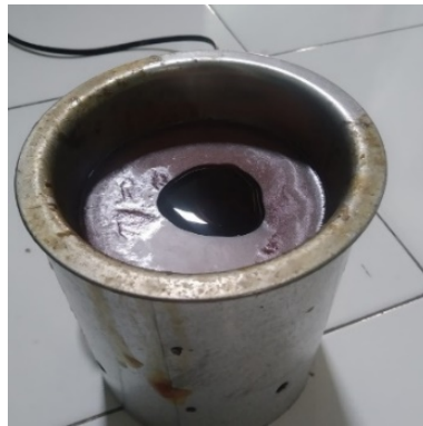
Gambar 6. Proses melelehkan malam dengan kompor listrik
