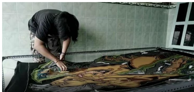
Gambar 9. Proses pelapisan kain dengan waterglass
