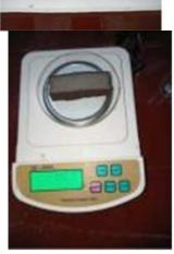
Setelah dicelupkan pada oli dan minyak spon tersebut ditimbang kembali agar mengetahui seberapa besar minyak atau oli yang diserap. Pada gambar tersebut spon yang sudah dilakukan uji coba menunjukkan angka 45,2 gram.
