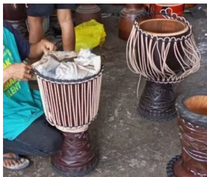
Gambar 3. Proses pemasangan tali dan kulit hewan
