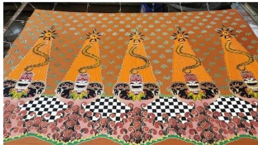
Gambar 10. Proses penguncian dengan *waterglass*
