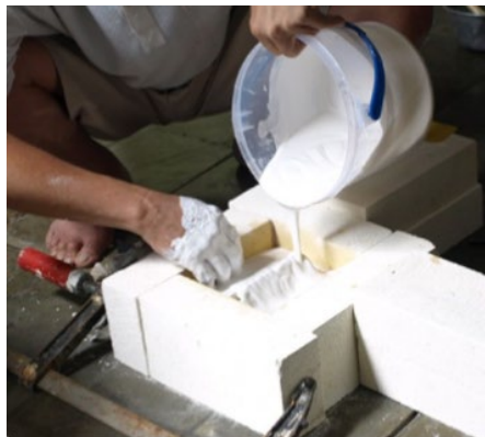
Gambar 11. Proses Pembuatan Gerabah Teknik Cor / Tuang (Sumber: keramik88.com)
