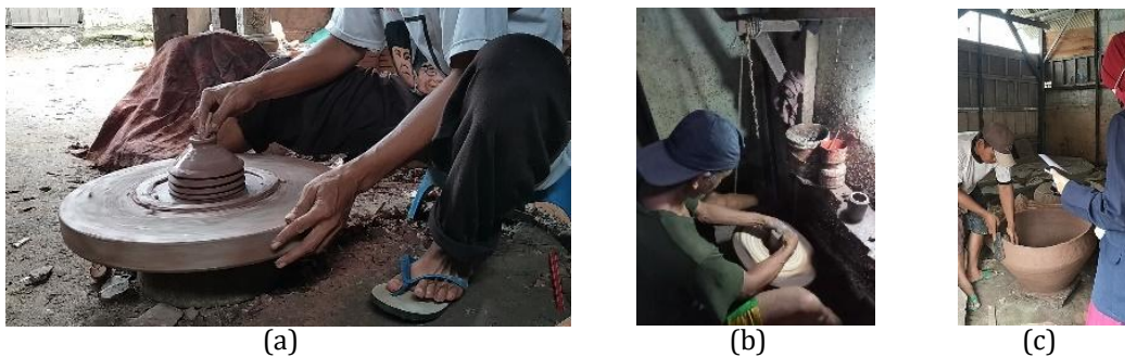
Gambar 9. Proses Pembuatan Gerabah Teknik Putar (a) Teknik Putar Tangan, (b) Teknik Putar Kaki, dan (c) Teknik putar sambung
