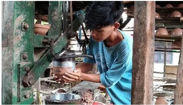
Gambar 10. Proses Pembuatan Gerabah Teknik Press
